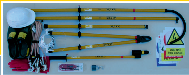
Ochranné pomůcky trafostanice
